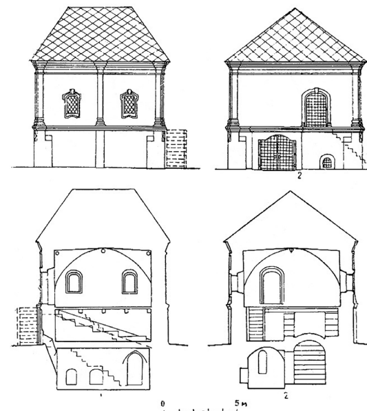
Рис. 21. Кам'яниця Дараганів. 1750–1770-ті рр. Фасади та поперечні розрізи (за М. Цапенком, 1967 р.)
