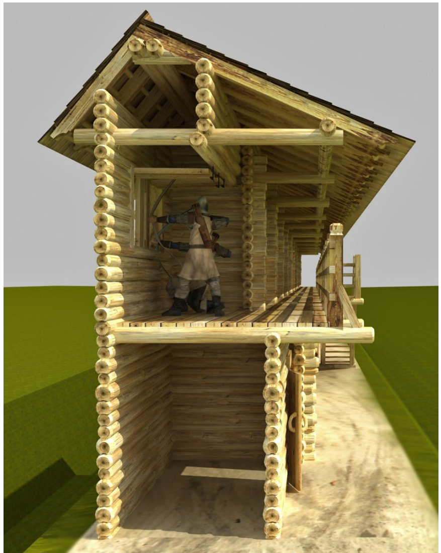
Ил. 19. Реконструкция двухъярусного укрепления. Поперечный разрез.
